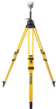
Базовый приемник с выносной УКВ антенной в режиме реального времени
